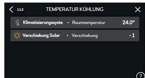
KNV Wärmepumpenanlagen, welche die PV-Smart-Funktion in Verbindung mit einem im Sommer aktiven Kühlbetrieb nutzen können, beziehen einen Großteil der zum Kühlbetrieb erforderlichen Elektroenergie aus Überschüssen der PV-Anlage. Somit können die Vorteile eines komfortablen Kühlbetriebs ohne signifikant erhöhte Betriebskosten genutzt werden.
